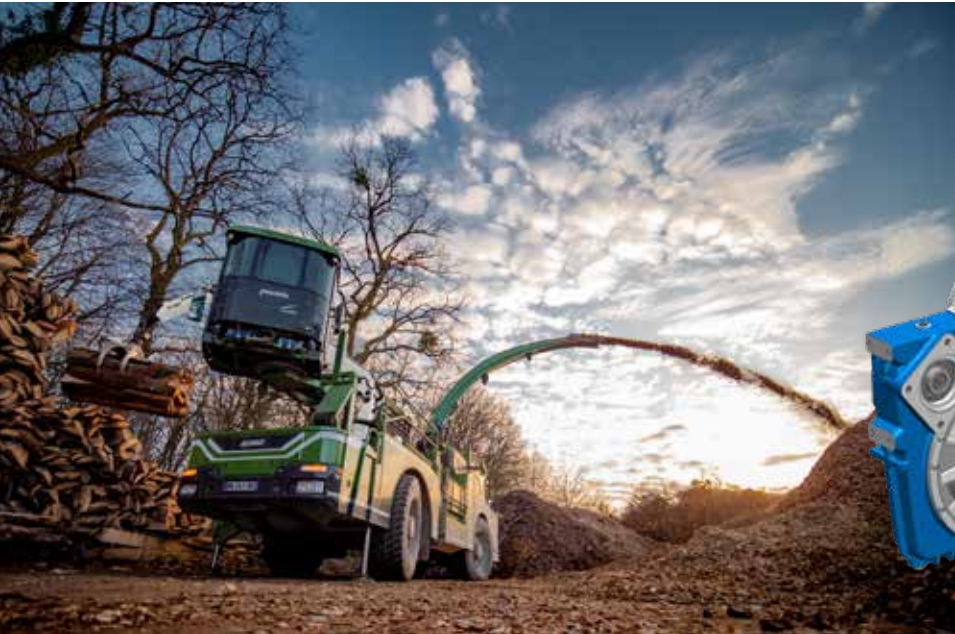
Motorabtriebsgetriebe für den Antrieb eines selbstfahrenden Holzhackers Engine power take-off gearbox for propelling a self-propelled wood chopper
