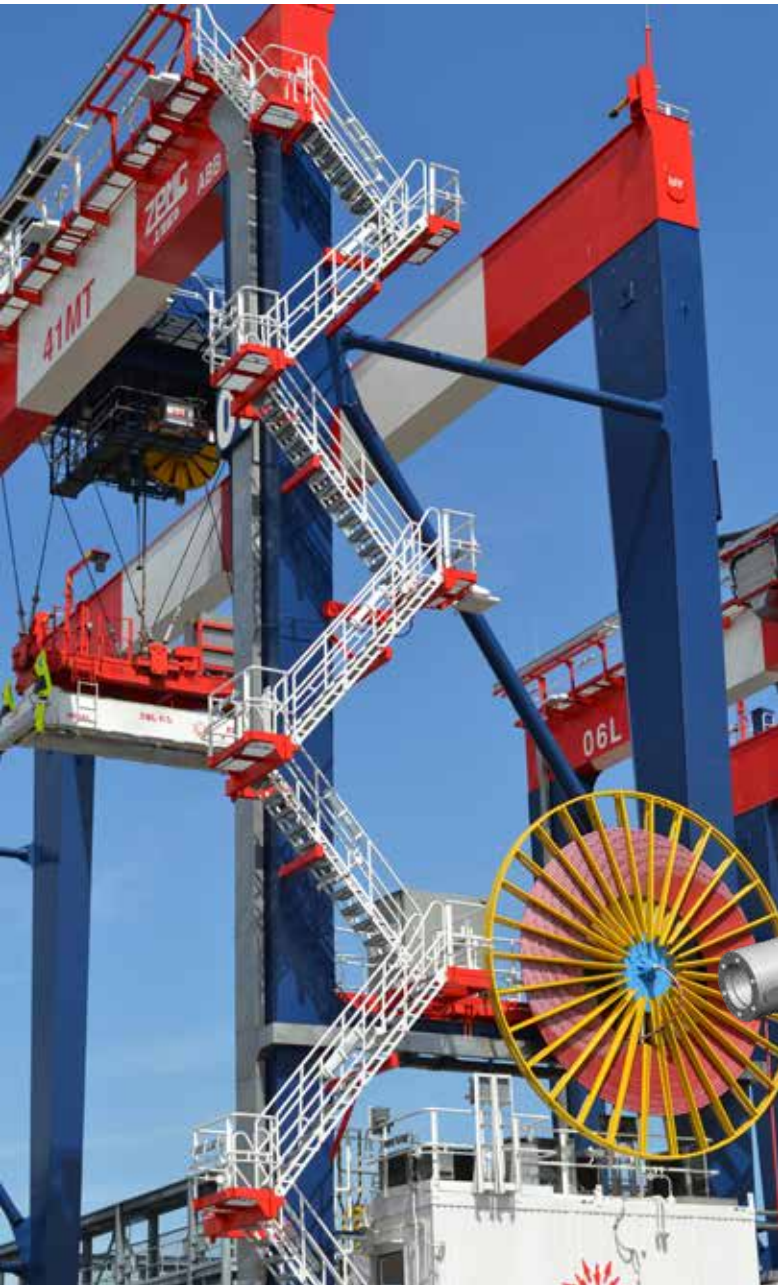
Kabeltrommelgetriebe für Kräne in Hafenanlagen Cabel drum gearbox for cranes in harbour facilities
